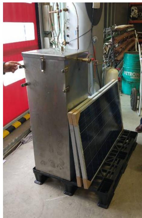
Potabilizadora solar para Haití
